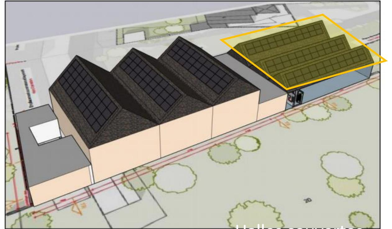
L'étude portée par le SDEF prévoit la réalisation d'une surface de couverture de 380 m<sup>2</sup> pour la mise en place de la centrale photovoltaïque pour l'ensemble des 2 bâtiments.
