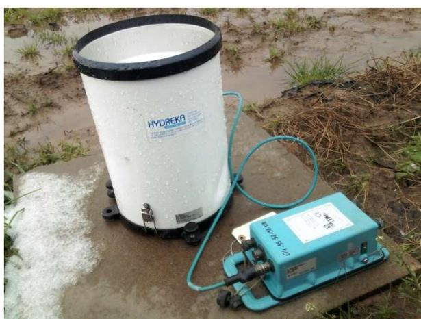
Figure 50 : Pluviomètre
