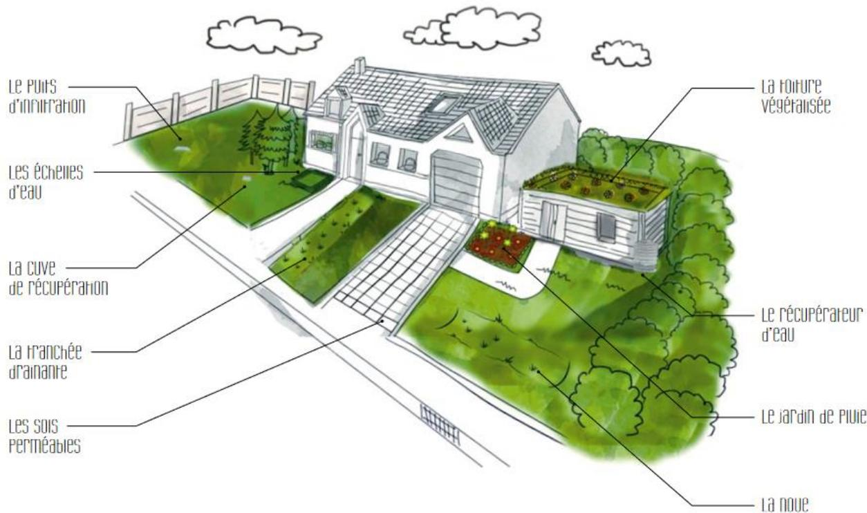
Exemples de gestion à la source par la mise en œuvre de techniques alternatives
