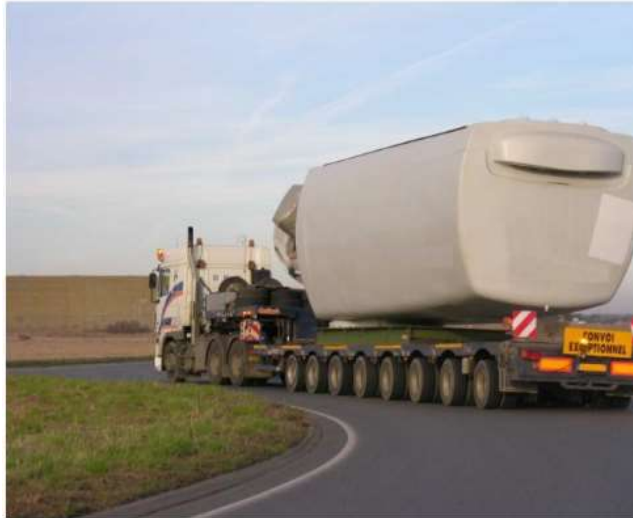
Figure 7 : Transport d'une nacelle
