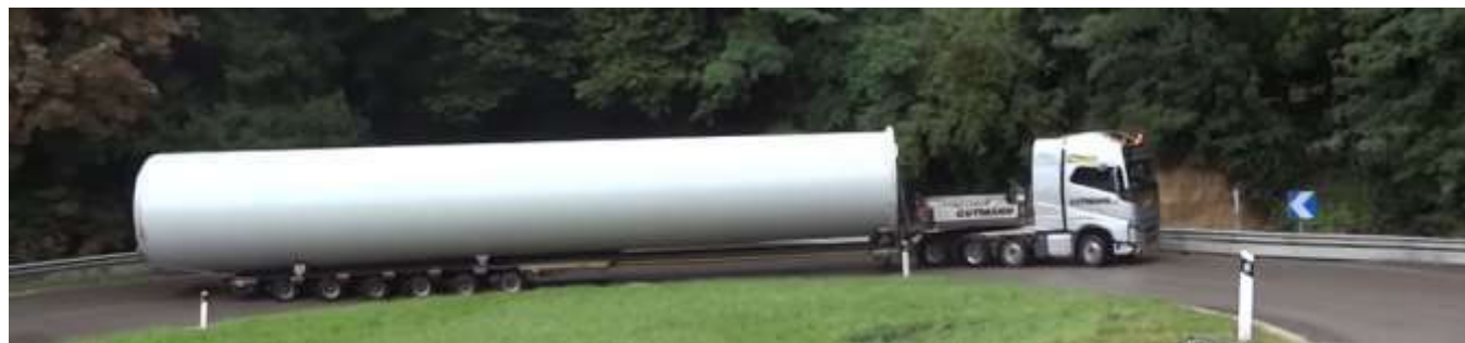
Figure 8 : Transport d'une section de mât
